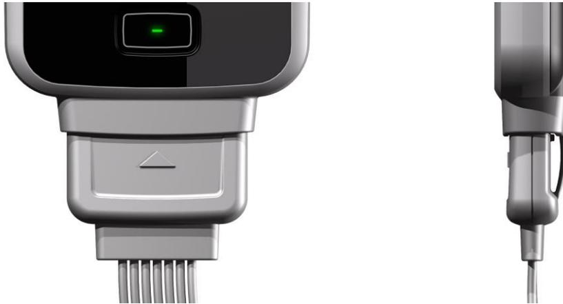
*Abb. 9 Anschlussbuchse des Patienten-kabels*
