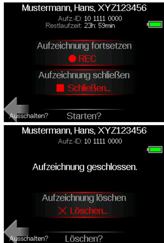
Abb. 10 Masken zum Schließen und/oder Löschen einer früheren Aufzeichnung
