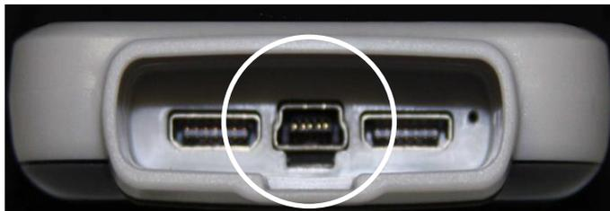
Abb. 6 USB-Anschluss zwischen den zwei Segmenten des Patienten-kabel-Anschlusses
