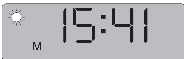
Bild 3-6 Beispiel: Anzeige nach bestandem Selbsttest (M= Messdaten im Speicher, ☀ Messphase Tag)
